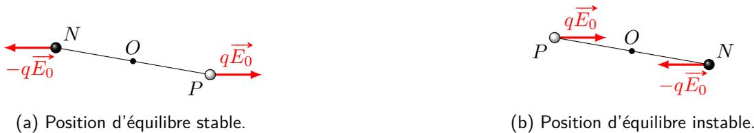
**Fig. 5** – Positions d'équilibre d'un dipôle électrostatique plongé dans un champ extérieur uniforme : le couple tend à aligner le dipôle avec le champ. Si ceux-ci sont parallèles mais de directions opposés, la position d'équilibre est instable car une petite perturbation tend à lui faire quitter cette position.
