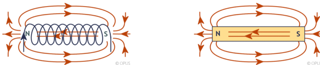
Fig. 11 – Similitudes entre les champs créés par un aimant et une bobine. Les deux sources de champs sont toutes deux équivalentes à un même moment magnétique orienté du pôle Sud vers le pôle Nord.
